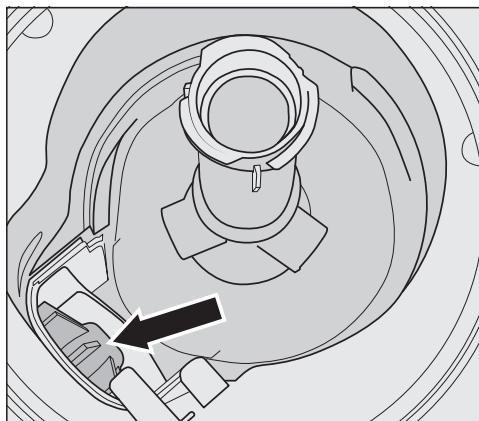
⚠ Poškození nesprávným čištěním. Součásti jsou choustivé a při čištění se mohou poškodit. Vypouštěcí čerpadlo čistěte opatrně.
