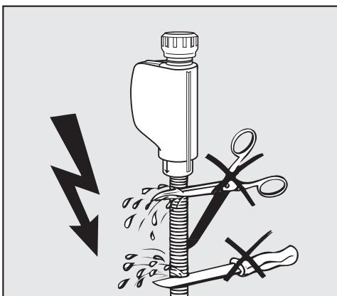
**⚠** Přívodní hadici nesmíte zkrátit nebo poškodit, protože jsou v ní elektrická vedení (viz obrázek).
