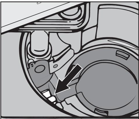
Pod zpětným ventilem je umístěné vypouštěcí čerpadlo (šipka).
