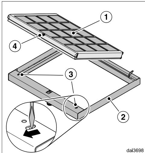
Filtr zapachów składa się z dwóch części. Kasetę filtru zapachów ① jest włożona w ramkę ②. Do regeneracji należy wyjąć kasetę filtru zapachów z ramki.
