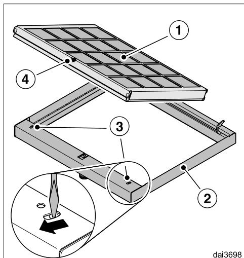
Вугільний фільтр складається з двох частин. Касета вугільних фільтрів ① вставлена в раму ②. Вийміть касету з рами для регенерації фільтрів.
