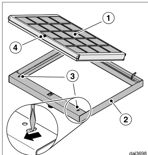
Угольный фильтр состоит из двух частей. Кассета с угольным фильтром ① вставлена в рамку ②. Выньте кассету с угольным фильтром из рамки для регенерации.
