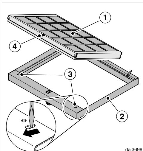
Το φίλτρο οσμών αποτελείται από δύο μέρη. Η θήκη του φίλτρου οσμών ① είναι τοποθετημένη σε ένα πλαίσιο ②. Αφαιρείτε τη θήκη του φίλτρου οσμών από το πλαίσιο για την αναγέννηση.
