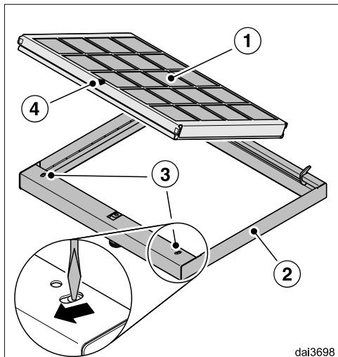
Pachový filtr se skládá ze dvou částí. Kazeta pachového filtru ① je nasazena v rámu ②. Pro čištění vyjměte kazetu pachového filtru z rámu.
