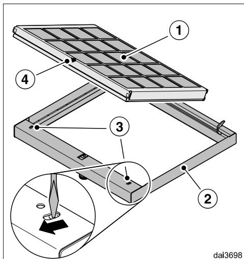
Der Geruchsfilter besteht aus zwei Teilen. Die Geruchsfilterkassette ① ist in einen Rahmen ② eingesetzt. Nehmen Sie die Geruchsfilterkassette zum Regenerieren aus dem Rahmen.
